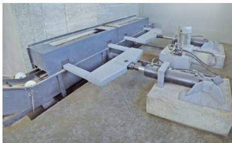
BEWEGUNG BEWEGLICHE EBENE UND FÖRDERBAND MISCARE PLAN MOBIL SI BANDA TRANSPORTOARE
