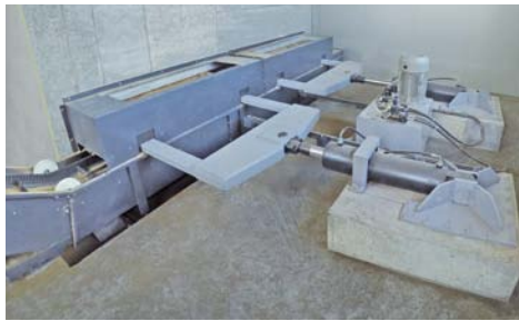
MOVIMENTAZIONE PIANO MOBILE E NASTRO DI TRASPORTO MOVING MOBILE TABLE, CONVEYOR BELT
